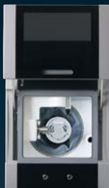
Frezowanie na sucho w Ceramill Motion 1 lub 2
