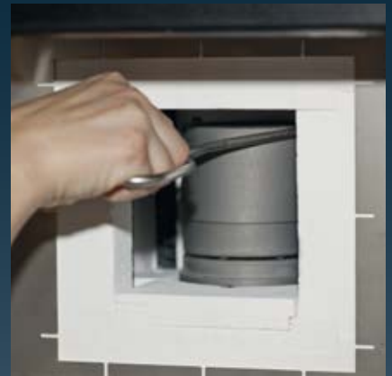
6 Położenie pokrywy i uruchomienie procesu synteryzacji
