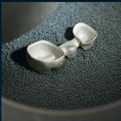
7 Uzupełnienie Ceramill Sintron® po synteryzacji oraz po wyjęciu z pieca syteryzacyjnego Ceramill Argotherm
